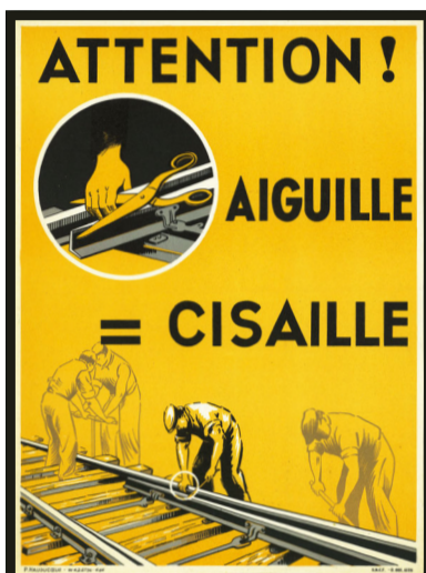
Cet ouvrier de la voie risque de se blesser en travaillant à main nue sur une aiguille. Auteur non identifié (1964)
